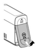
Per sostituire la bombola è sufficiente rimuovere il pannello frontale del frigo-gasatore.
